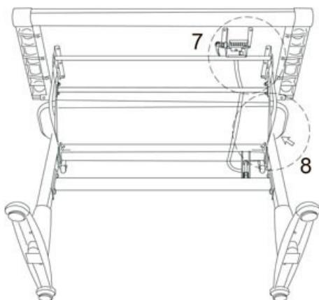
6. Протяните блок регулировки между перекладиной (F) и механизмом (E).
