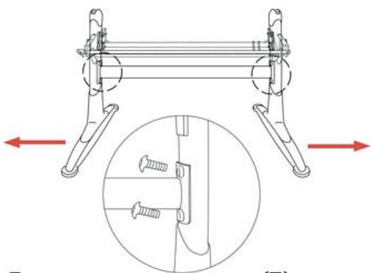
2. Вставьте перекладину (F) между ног стола (С) и зафиксируйте ее, используя винты (2) и ключ (9).
