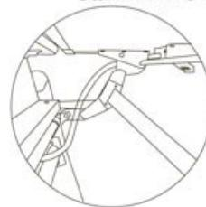
5. Прикрепите ноги (С) к столешнице (В) винтами (1) и ключом (9). После этого крепко затяните винты на кронштейнах
