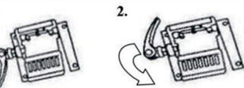
Чтобы избежать непроизвольного поднимания столешницы, на механизме регулировки высоты предусмотрен рычаг, который его блокирует.
