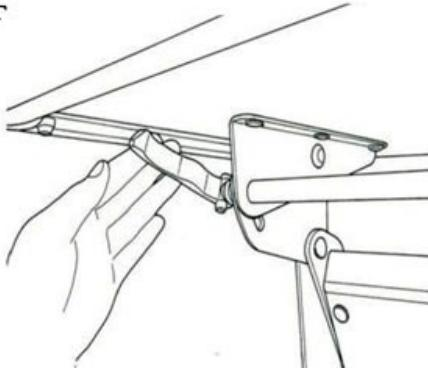
В случае недостаточной фиксации угла наклона столешницы, проверните регулировочную гайку на несколько градусов.
