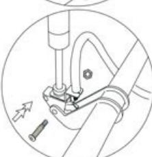
4. Прикрепите низ газ-лифта к механизму регулировки (E) с помощью винта (5), гайки (7) и ключей (8) и (10).
