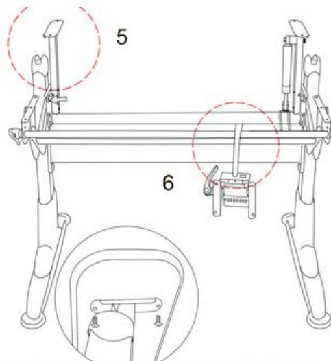
1. Зацепите механизм (E) за отверстие на ногах (C), как показано на рисунке, и закрепите его в таком положении с помощью винтов (6) и ключа (8). Крепко зажмите все винты.
