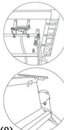
7. Прикрепите блок регулировки к столешнице (A) с помощью винтов (1) и ключа (9).
