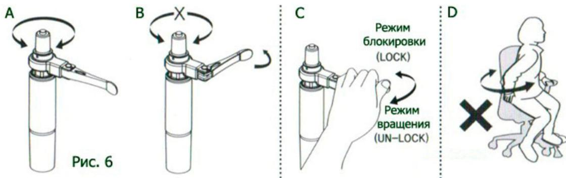
**6. Блокировка/разблокировка вращения кресла осуществляется с помощью рычага на газ-патроне, как показано на Рис. 6.**
