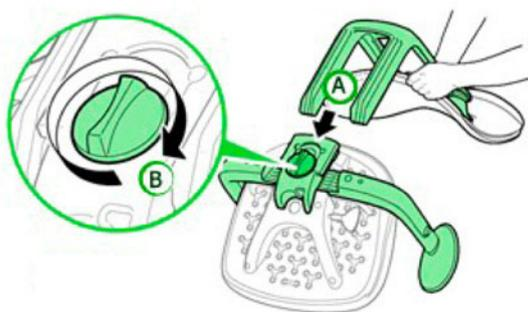
2. Установите крепления спинки кресла в полозья на нижней стороне сиденья и затяните ручку под сиденьем по часовой стрелке таким образом, чтобы спинка и сиденье были надежно закреплены.
