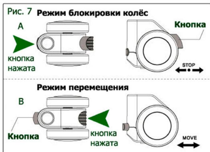
**7. Когда Вы нажимаете кнопку блокировки, как показано на Рис. 7.A, движение колес блокируется под весом сидящего. Если нажать кнопку с обратной стороны колесика, как показано на Рис. 7.B, движение разблокируется.**
