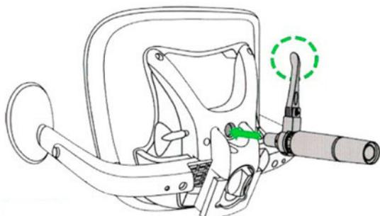
3. Для удобства работы поверните рычаг газ-патрона Дуалиндр в горизонтальное положение. Вставьте газ-патрон в гнездо, расположенное в центре нижней стороны сиденья.
