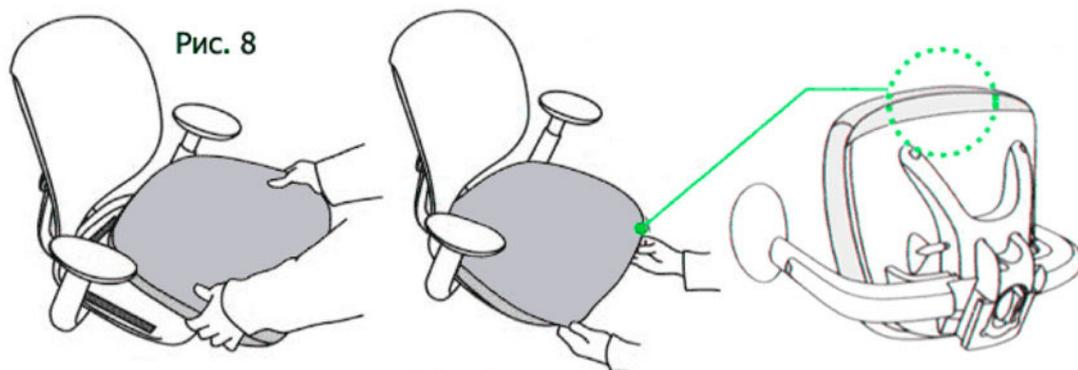
**8. Для чистки обивки сиденья кресла снимите мягкую часть сиденья. Для этого нужно отсоединить мягкую часть сиденья от «липучек» на верхней части каркаса и слегка потянув вперед снять обивку с передней части каркаса, как показано на Рис. 8.**
