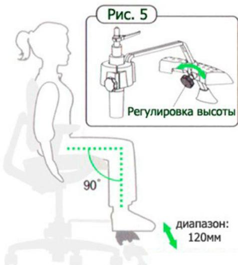
**5. Высота подножки регулируется с помощью ручки на внутренней стороне подножки, как показано на Рис. 5. Предусмотренный диапазон регулировки высоты - 120 мм.**
