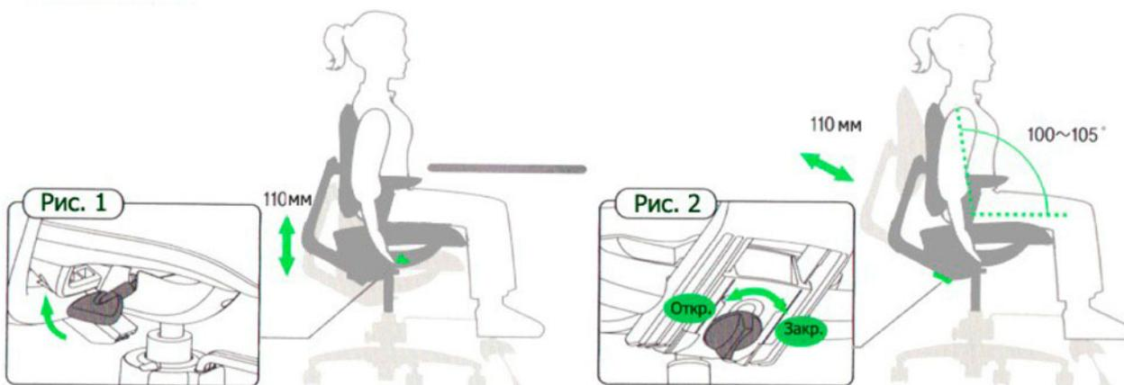
1. Отрегулируйте высоту посадки в зависимости от высоты столешницы с помощью рычага регулировки, как показано на Рис. 1.
