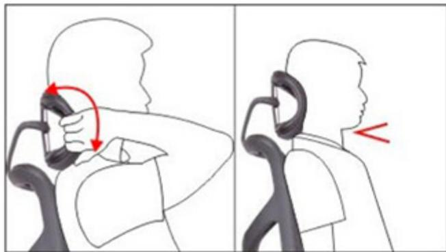
3. Возьмитесь за подголовник, чтобы отрегулировать угол наклона. Предусмотрена возможность регулировки в диапазоне 80 градусов.
