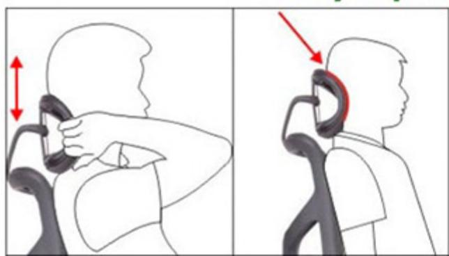
1. Возьмитесь за подголовник, чтобы отрегулировать его высоту. Диапазон регулировки - 70 мм.
