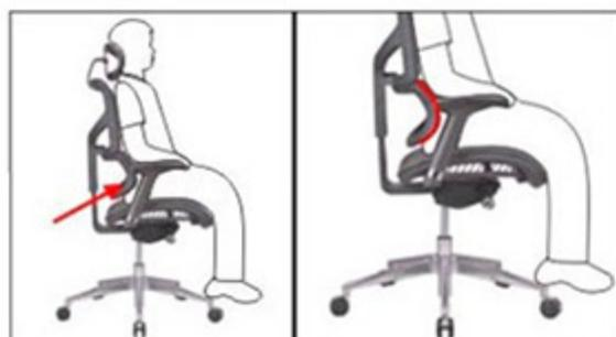
1. При плотном прилегании спины к спинке кресла, а поясницы к поясничной поддержке, достигается наиболее комфортное положение пользователя в кресле, нагрузка со спины снимается.
